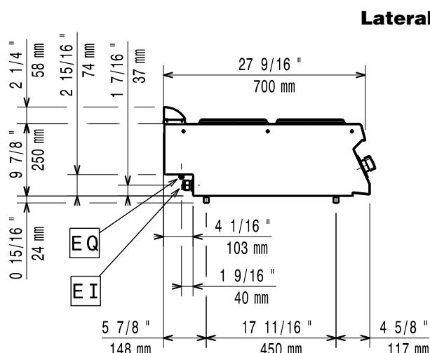
**EI** = Conexión eléctrica (energía)
